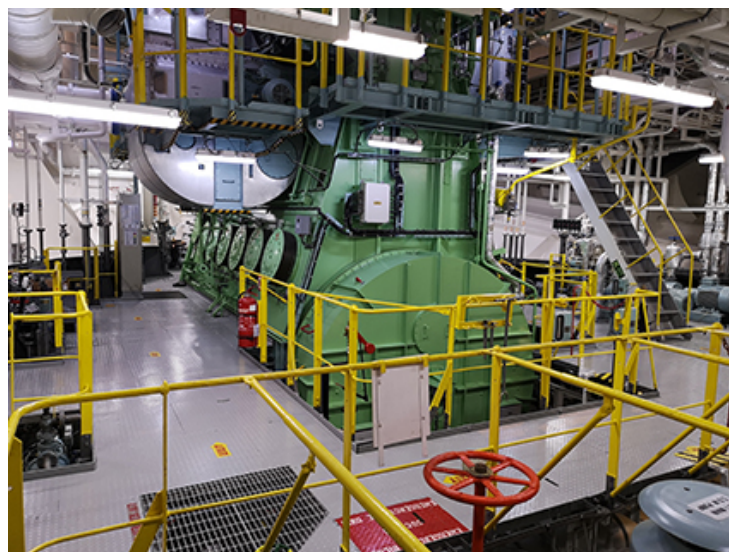
Eine weitere Ansicht des ME-LGIM-Motors der „Mari Jone“ (Bild mit freundlicher Genehmigung von Marinvest)
