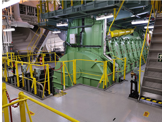
Blick auf den MAN B&W ME-LGIM-Motor der ersten Generation an Bord der „Mari Jone“, einem methanolbetriebenen Dual-Fuel-Tanker, den Waterfront Shipping im Jahr 2016 übernommen hat. Zu beachten ist die Sauberkeit im Maschinenraum (Bild mit freundlicher Genehmigung von Marinvest)
